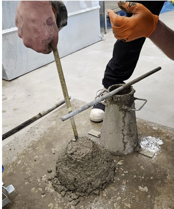
Kuva 2: painuman mittaus painumakartion avulla (kuva: Salla Pulliainen)
