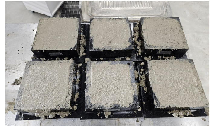
Kuva 4: koekappaleet muoteissaan (kuva: Salla Pulliainen)
