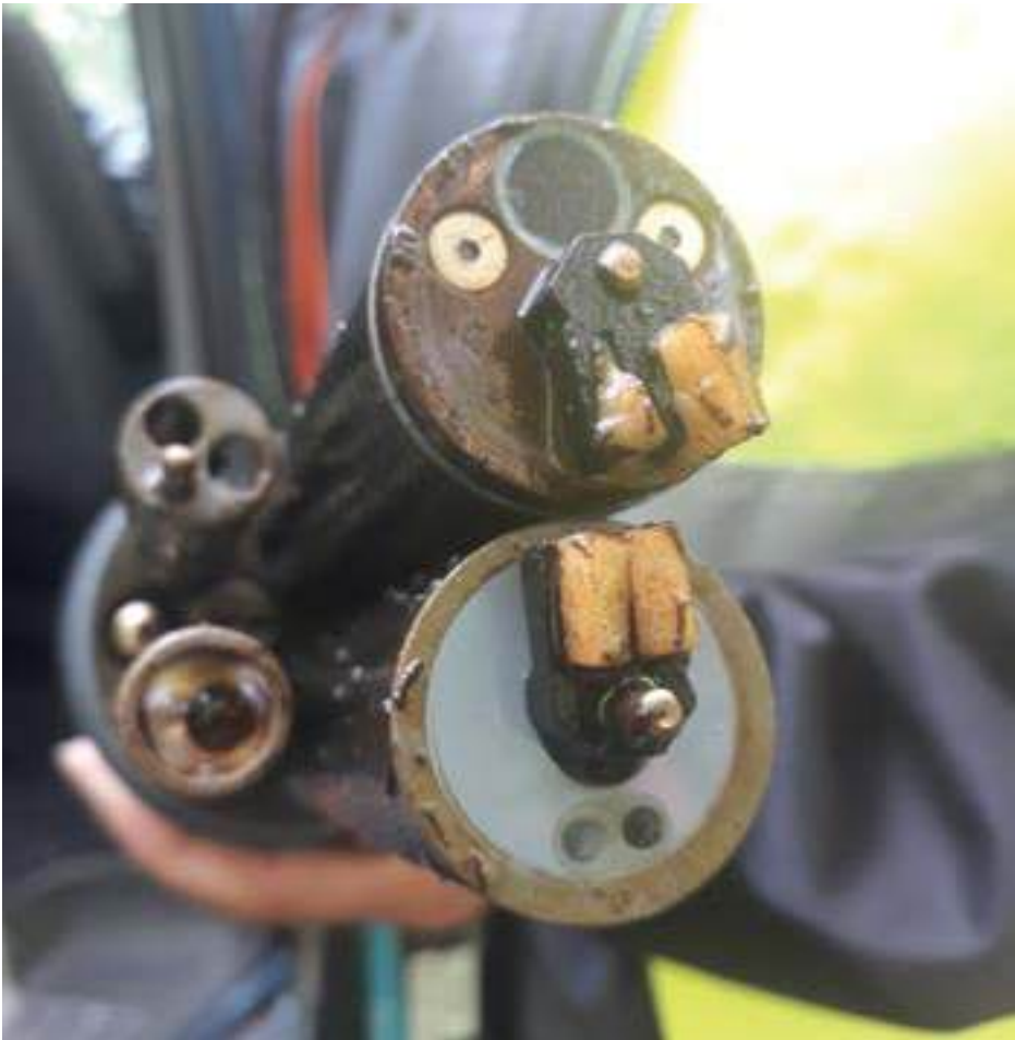
Kuva 2. Pintavedessä käytetyn jatkuvatoimisen YSI 6920-V2 -vedenlaatusondin optisen sameusanturin likaantuminen ja puhdistusharjan puhdistama osa. (Kuva Aki Mykkänen)
