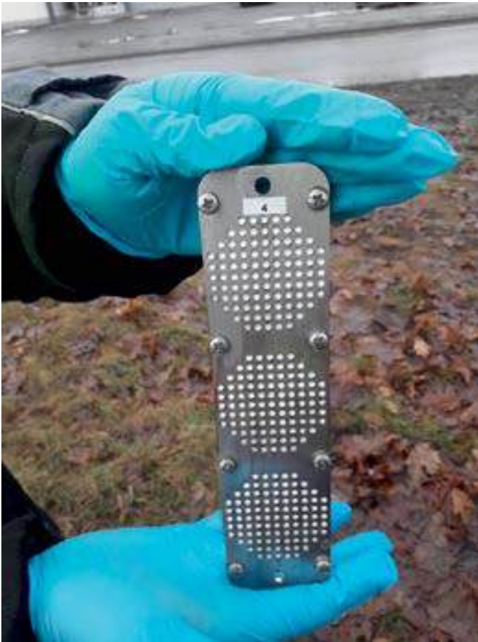
Kuva 4. Valmis passiivinäytteenotin ennen pohjavesiputkeen asentamista. (Kuva Aki Mykkänen)
