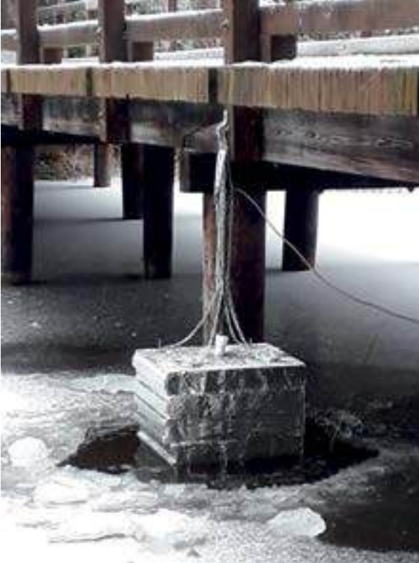
Kuva 4. VEMIDI-hankkeessa pintaveden ympärivuotiseen monitorointiin hyödynnetty vedenlaatumittarille tehty lämpöeristetty lautta. (Kuva Niina Laurila)
