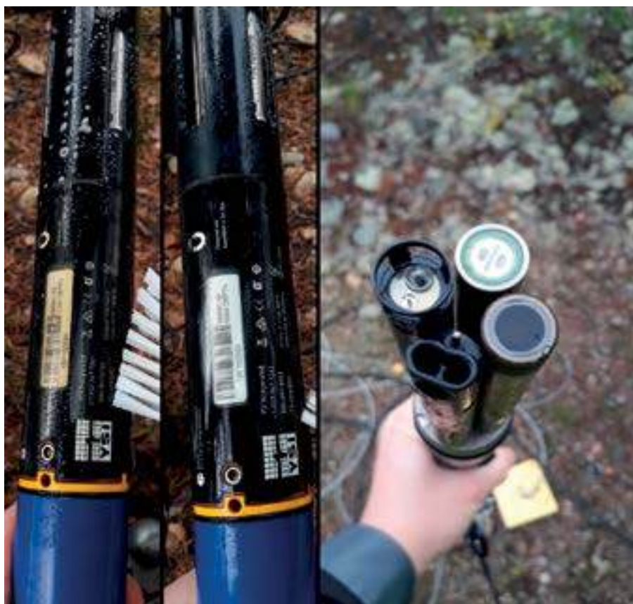
Kuva 4. Sondin tummuminen (vasen) sekä anturipäiden puhtaus noin 6 kuukauden puhdistamatta olemisen jälkeen. (Kuva Aki Mykkänen)
