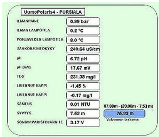
Kuva 10. Pursialan monitorointiaseman tulosten käyttöliittymä vesilaitoksen MISONET-valvomonäkymässä. (Kuva Jyrki Ikonen)
