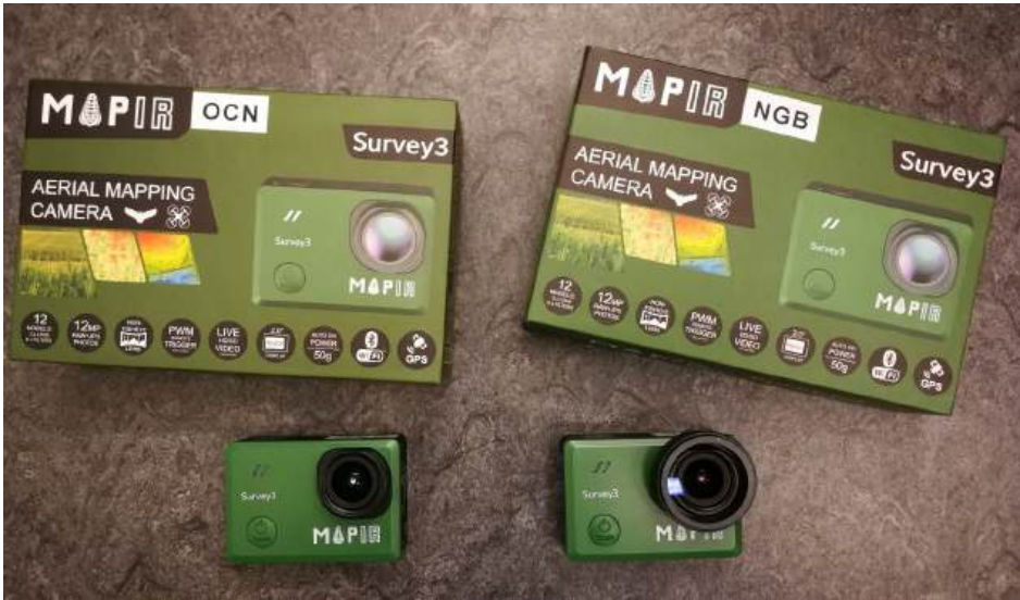
Kuva 3. Dronekäyttöön sopivia pienikokoisia kolmen kanavan multispektrikameroita. Kuvassa NGB- ja OCN-kamerat. (Kuva Esa Hannus)
