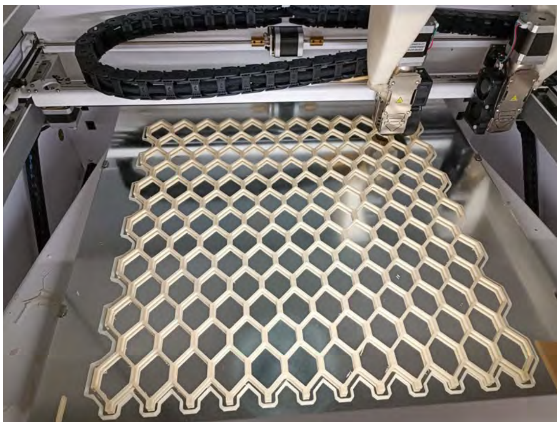
Kuva 23. Aalto-yliopistolle Tumaker -laitteella 3D-tulostettu honeycomb -kennorakenne (430 mm x 430 mm) UPM Formi 3D -materiaalista (kuva: Eetu Huttunen).
