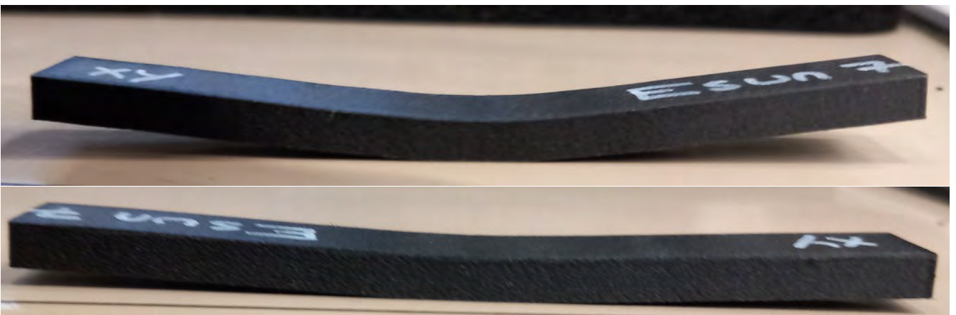
Kuva 15. Suurin osa taipuman palautumisesta tapahtui 14 minuutin aikana (kuvienoton aikaväli).
