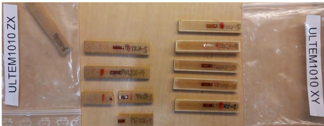
Kuva 70. ULTEM1010-koesarjojen puristuslujuuskoekappaleet XY- ja ZX-tulostussuunnissa.
