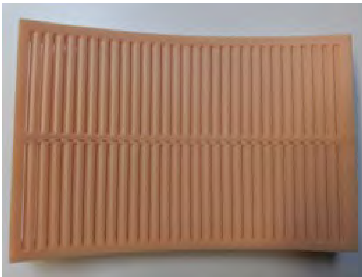
Kuva 27. 3D-tulostettu painelajittimen lankarakosihti (Kuva: Mikko Nykänen).
