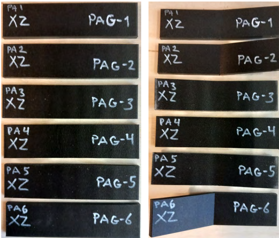
Kuva 77. PA6/66 + CF 20 % xz-suunta-koesarjan iskulujuuden koekappaleet ennen ja jälkeen koestuksen.
