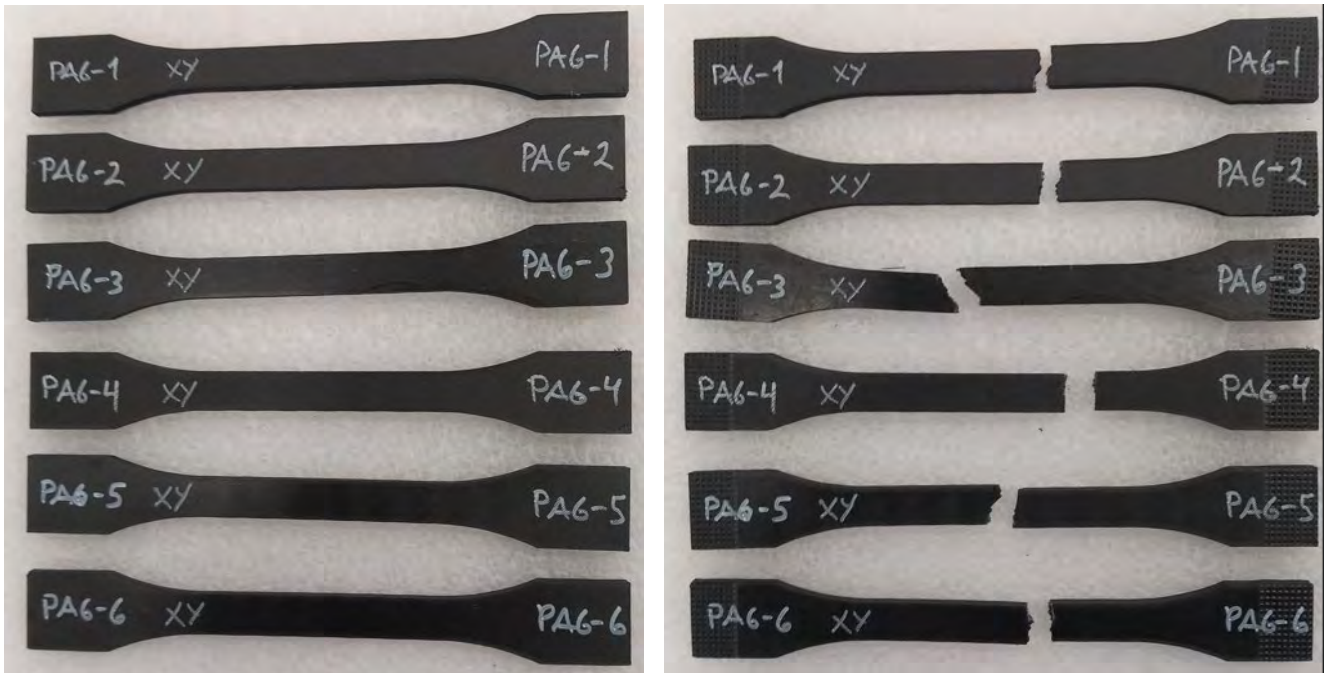
Kuva 1. PA6/6+CF 20 % -koesarjan vetokoekappaleet; tulostussuunta XY.
