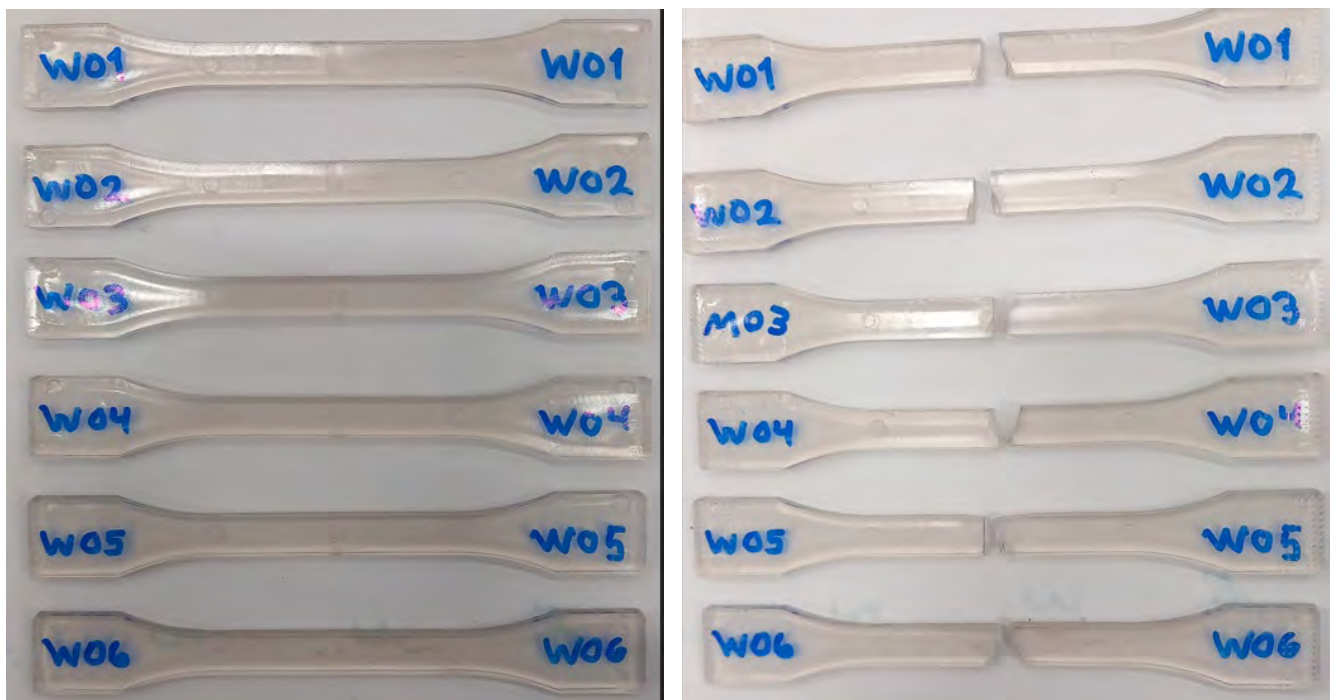
Kuva 9. Woodly W204C -koesarjan vetokoekappaleet.
