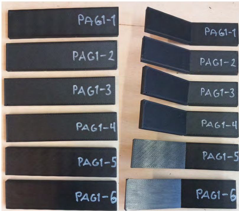
Kuva 76. PA6/66 + CF 20 % xy-suunta-koesarjan iskulujuuden koekappaleet ennen ja jälkeen koestuksen.
