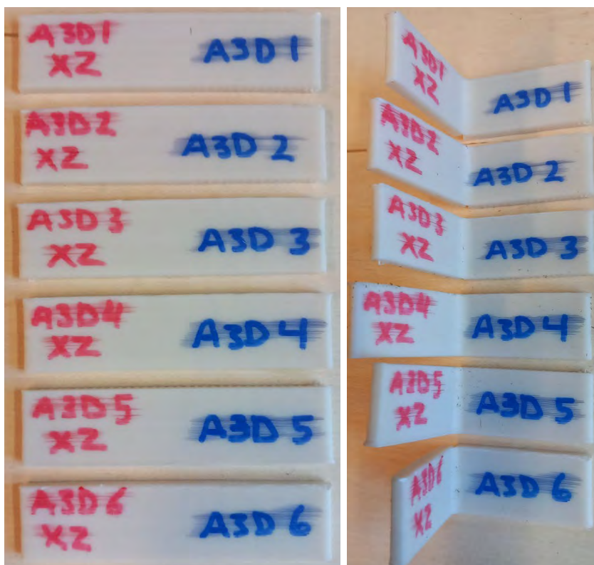
Kuva 80. ASA 3D-tulostettu xz-suunta-koesarjan iskulujuuden koekappaleet ennen ja jälkeen koestuksen.
