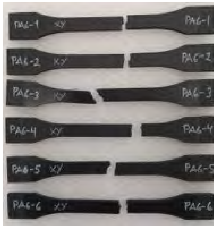
Kuva 25. Murrettuja PA6 GF 30% -vetokoesauvoja (Kuva: Kai Möller).
