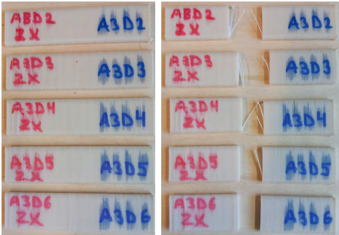
Kuva 81. ASA 3D-tulostettu zx-suunta-koesarjan iskulujuuden koekappaleet ennen ja jälkeen koestuksen.
