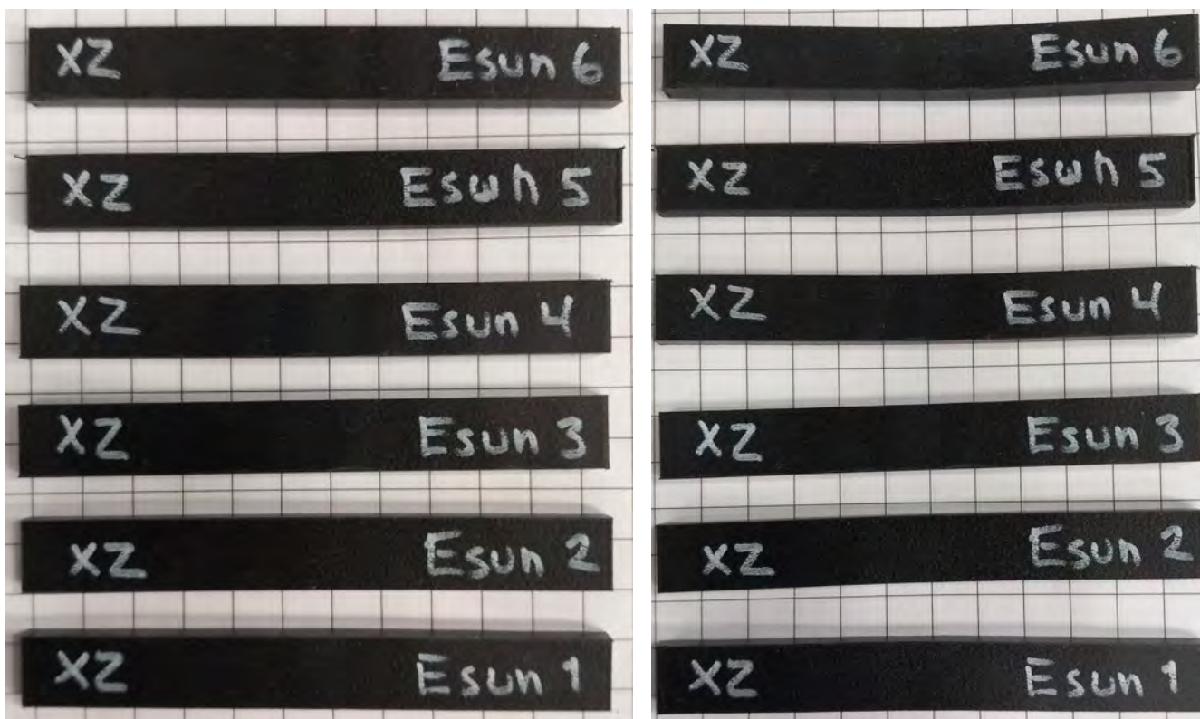
Kuva 16. PA6/6+CF 20 % -koesarjan taivutuskoekappaleet; tulostussuunta XZ.
