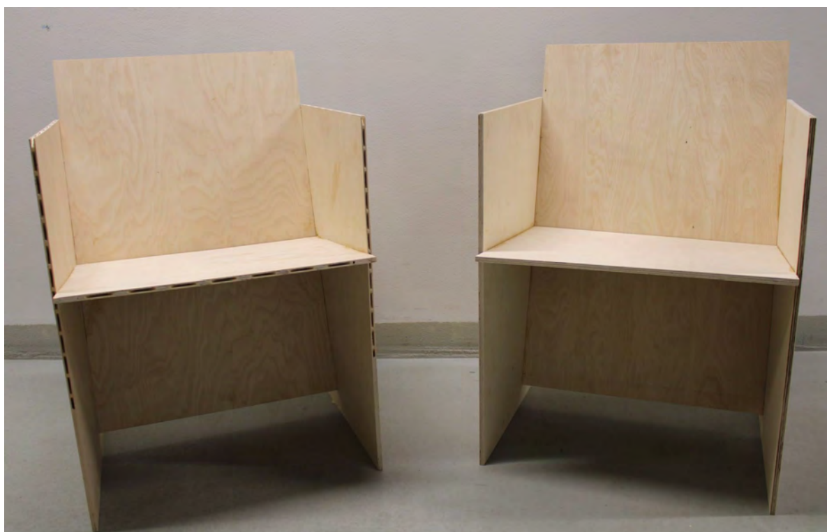
Kuva 20. Hankkeessa demonstroitu kennorakenteinen tuoli (vasemmalla), ja vertailukohtaksi valmistettu umpivanerista valmistettu tuoli (oikealla), (Kuva: Mahyar Fazeli).
