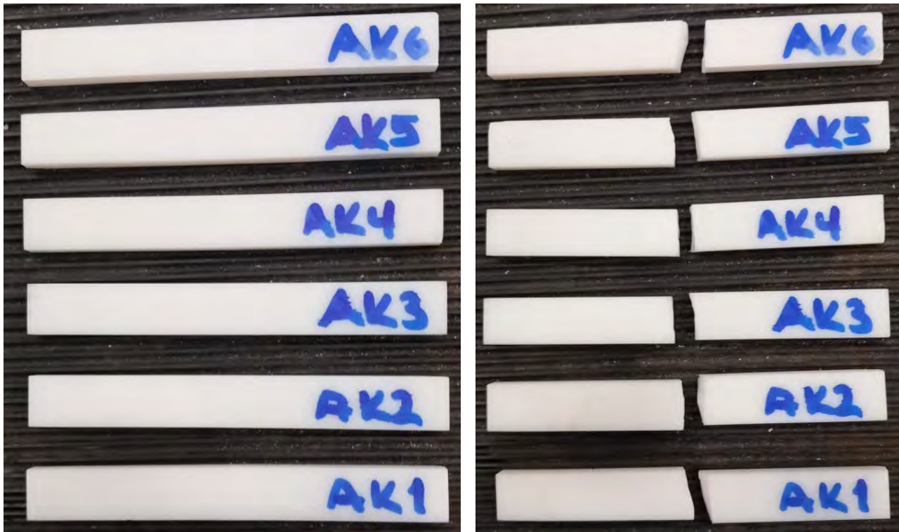
Kuva 22. Rigid 10K akrylaatti-koesarjan taivutuskoekappaleet.
