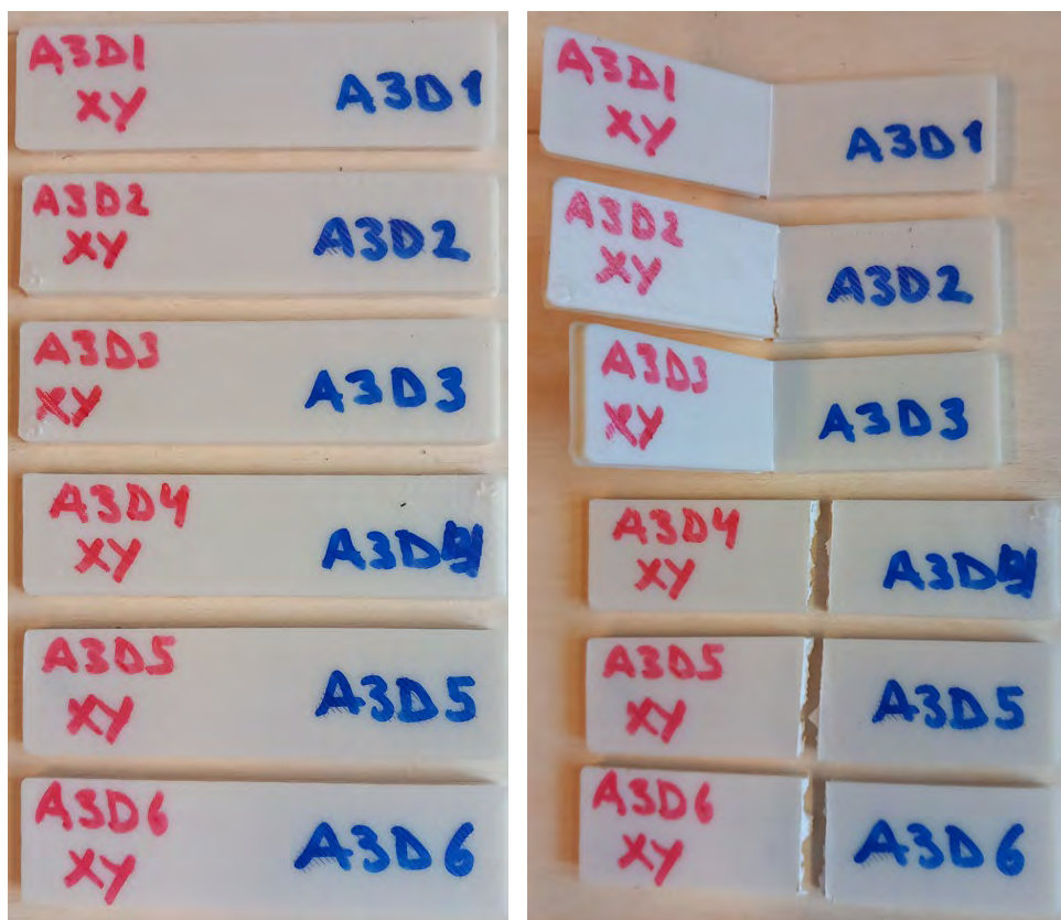
Kuva 79. ASA 3D-tulostettu xy-suunta-koesarjan iskulujuuden koekappaleet ennen ja jälkeen koestuksen.
