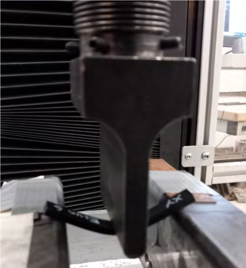
Kuva 14. Esun-koesarjojen koekappaleet kestivät voimakkaan taipuman murtumatta.
