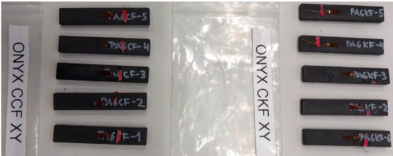
Kuva 67. Onyx CCF- ja Onyx CKF -koesarjojen puristuslujuuskoekappaleet XY-tulostussuunnassa.
