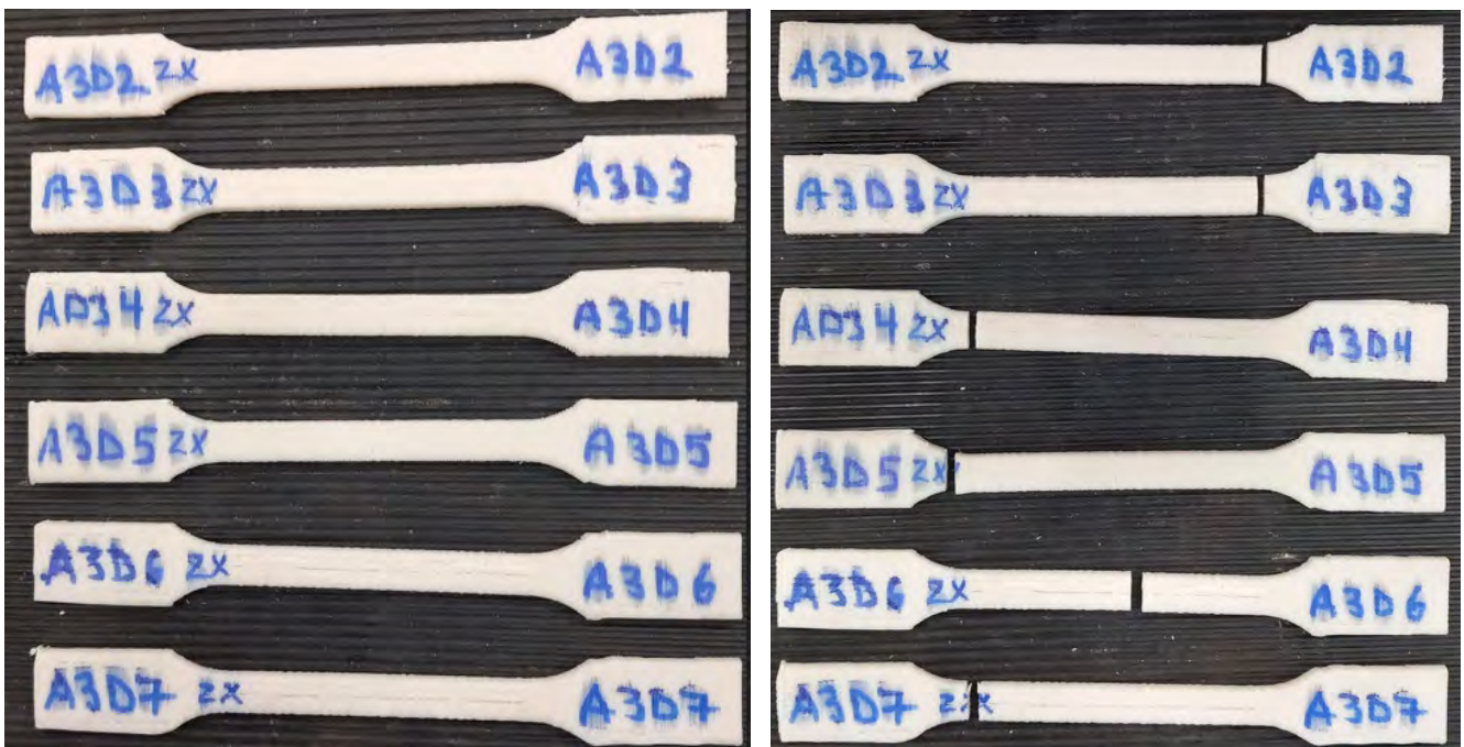
Kuva 6. ASA 3D-koesarjan vetokoekappaleet; tulostussuunta ZX. Kappaleen A3D5-ZX luisti puristusleukojen välissä saaden vääristyneet arvot, joten se suljettiin pois laskennasta.
