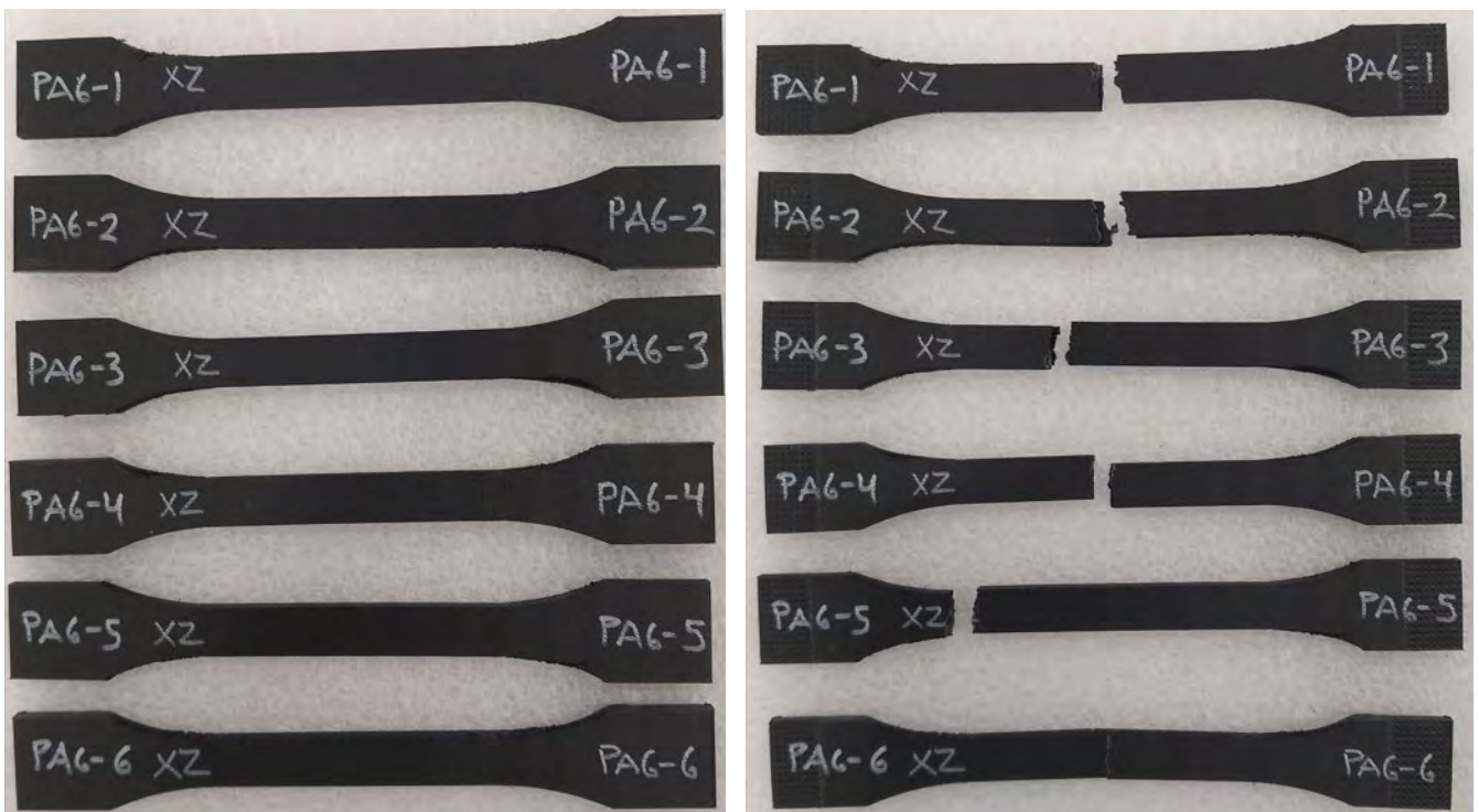
Kuva 2. PA6/6+CF 20 % -koesarjan vetokoekappaleet; tulostussuunta XZ.
