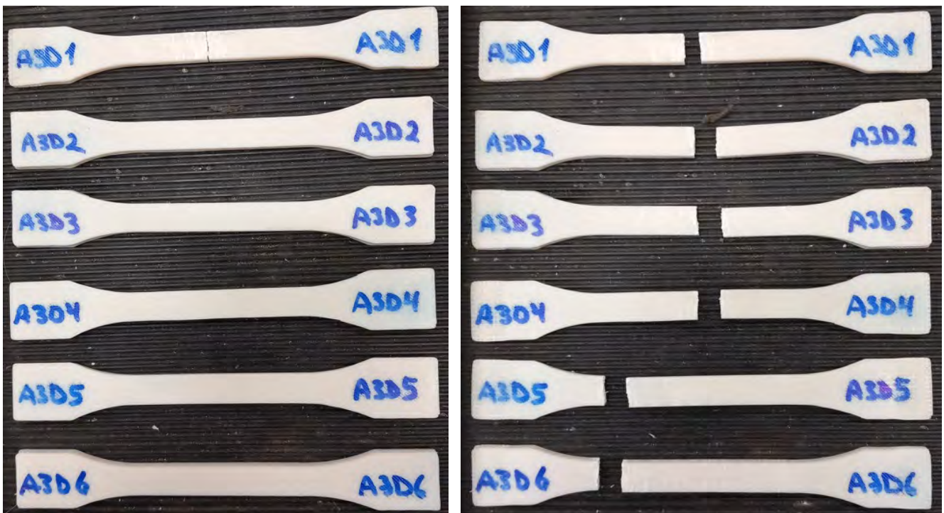
Kuva 4. ASA 3D-koesarjan vetokoekappaleet; tulostussuunta XY.
