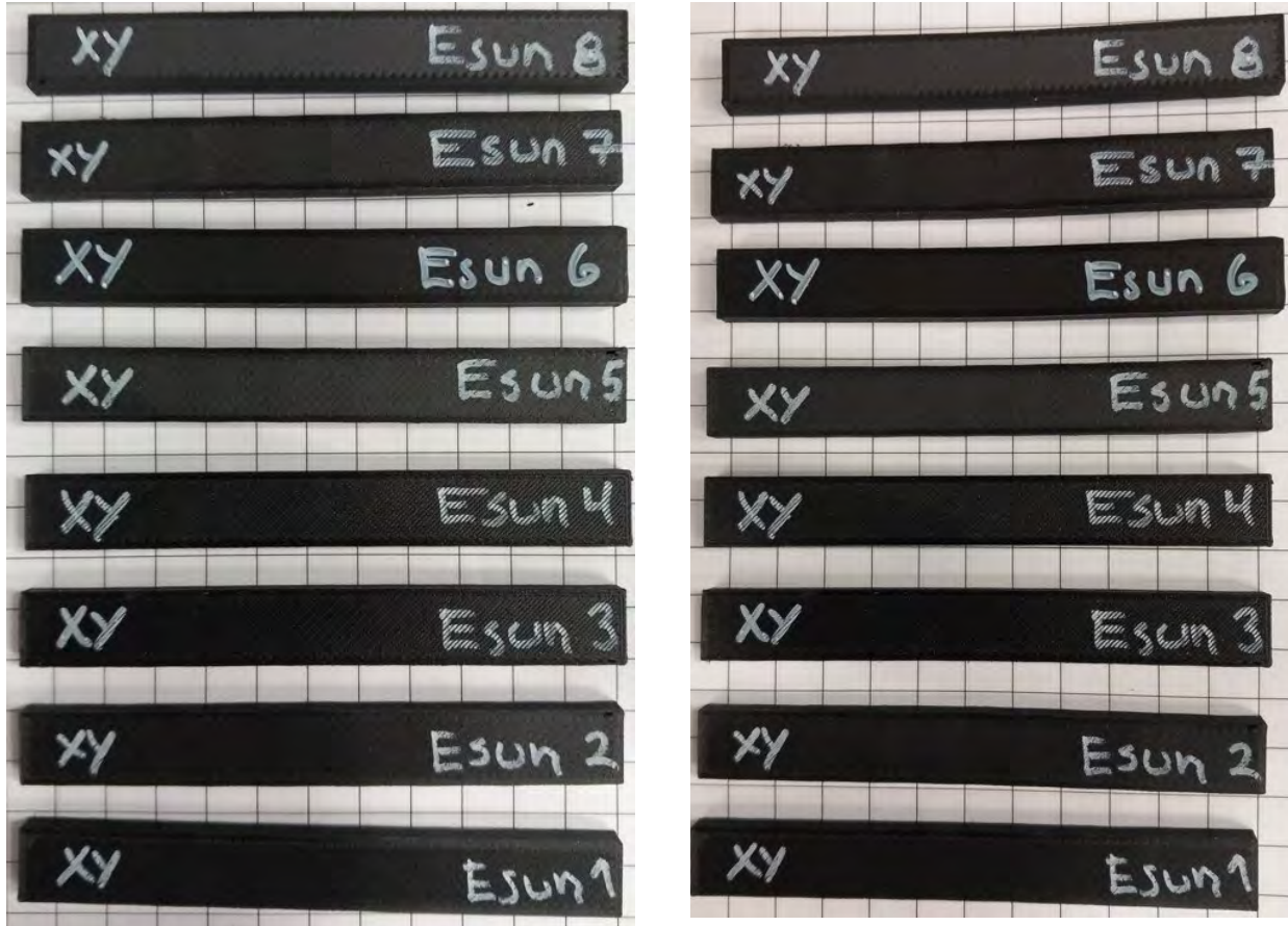
Kuva 13. PA6/6+CF 20 % -koesarjan taivutuskoekappaleet; tulostussuunta XY.
