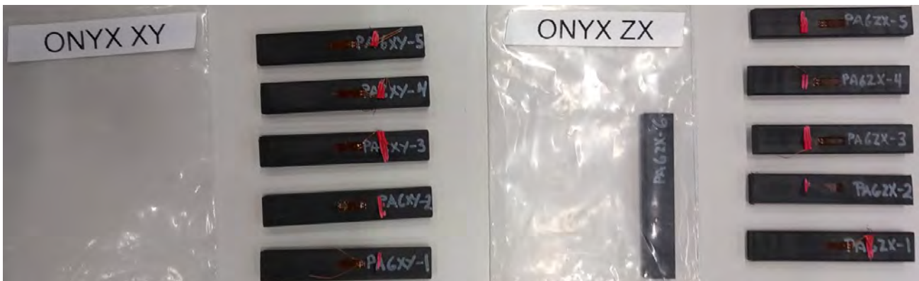
Kuva 68. Onyx -koesarjojen puristuslujuuskoekappaleet XY- ja ZX-tulostussuunnassa.
