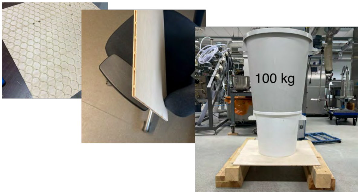
Kuva 18. Kuvassa a Xamkillä 3D-tulostettu hunajakennorakenne, kuvassa b kennolevyn rakenne ja kuvassa c kennolevyn kestävyys testaus (Kuvat: Mahyar Fazeli).
