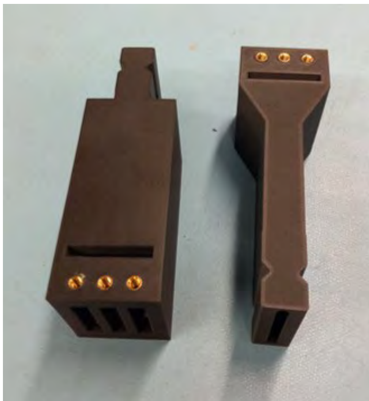
Kuva 33. Stanssaustyökalukotelo särmäimeen (Kuva: Mikko Nykänen).
