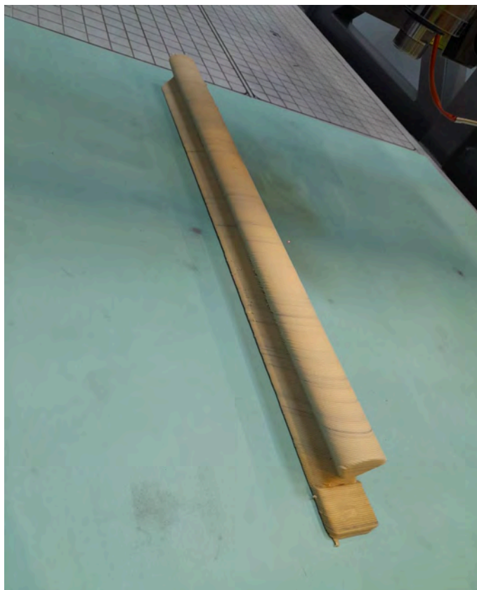
Kuva 7. Porraskaiteen käsijohdin, joka on tulostettu Super Discovery Workstation -laitteistolla Teollisen puurakentamisen laboratoriossa Savonlinnassa (Kuva: Eetu Huttunen).
