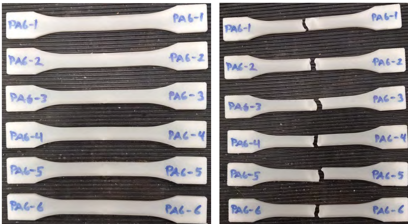
Kuva 10. PA6 GF 30 % -koesarjan vetokoekappaleet.
