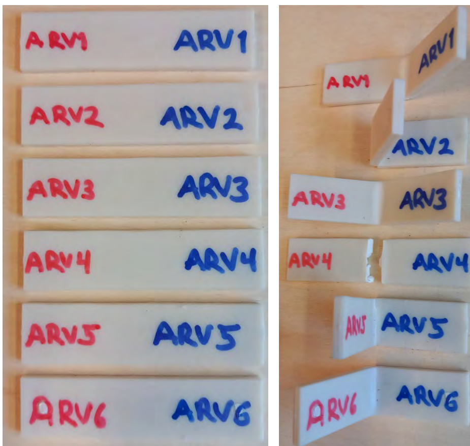
Kuva 82. ASA ruiskuvalettu-koesarjan iskulujuuden koekappaleet ennen ja jälkeen koestuksen.
