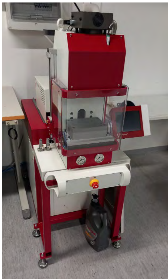
Kuva 1. Ruiskuvalukone Babyplast 6/10VP Elektroniiikan 3K-tehtaalla (Kuva: Mikko Nykänen).
