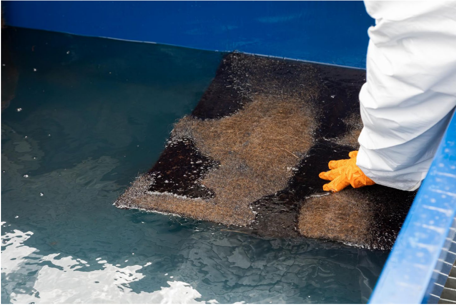
Kuva 4. Hiukkamatto testialtaassa imeytystestissä (kuva: Mervi Koistinen 2022)
