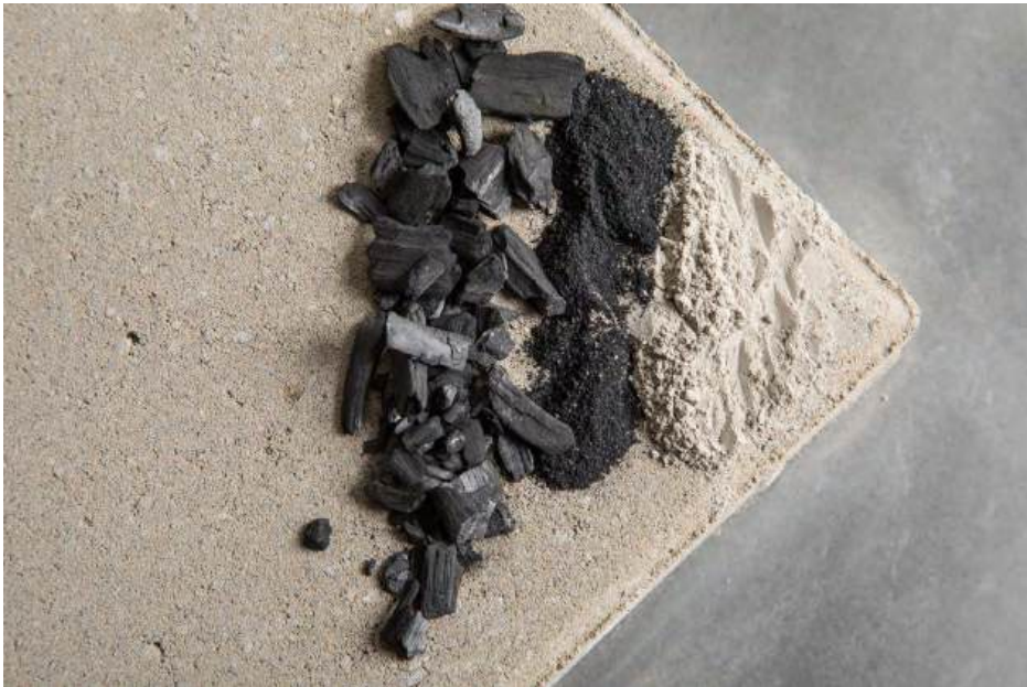
KUVA 1. Biohiilellä voidaan korvata sementtiä betoniseoksissa (kuva Manu Eloaho).
