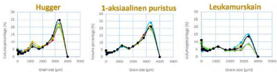
KUVA 5. Partikkelikokojakaumat Hugger-murskaimella, leukamurskaimella ja yksiakiaalisten puristuskokeiden avulla hienonnetuista kivit tuotteista (kuva Niina Paasovaara).
