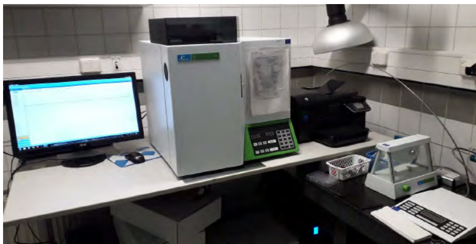
KUVA 1. CHNS/O-laitteisto (kuva Marjatta Lehesvaara)
