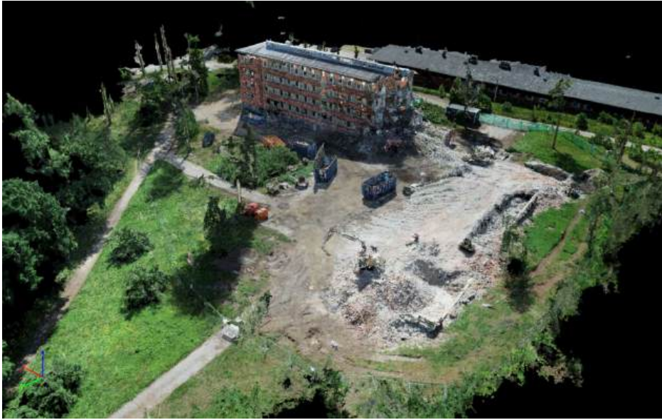
KUVA 4. 3D-pistepilvimalli Tuukkalan purkutyömaasta (kuva Juha Vihavainen).
