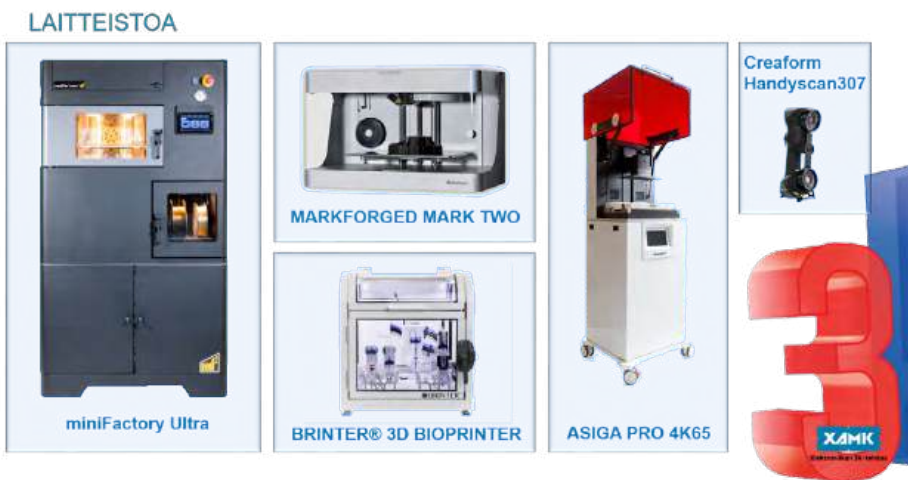
KUVA 1. AMAP-laitteistoa. Vasemmalla vaativiin kohteisiin tarkoitettujen muovien lankatulostin Ultra, siitä oikealla ylhäällä ns. komposiittitulostin Mark Two, sen alapuolella bioprintteri Brinter, edelleen oikealla hartsitulostin Asiga ja oikeassa yläkulmassa 3D-skanneri Handyscan 307 (kuvakollaasi Mari Rasku).
