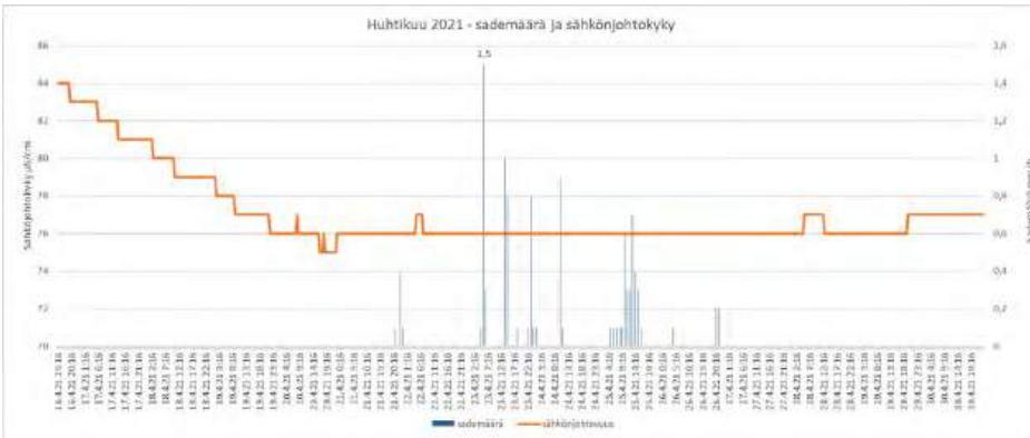
KUVA 8. Sademäärät ja sähköjohtokyky huhtikuussa 2021
