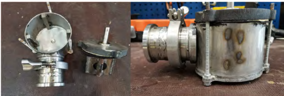
KUVA 2. Pieni sekoitin kaasudispersiokokeisiin. Sekoitinta voidaan ajaa akkukäyttöisellä porakoneella, ja se on mahdollista ottaa mukaan tehtaalle. (kuva Antti Pappinen)
