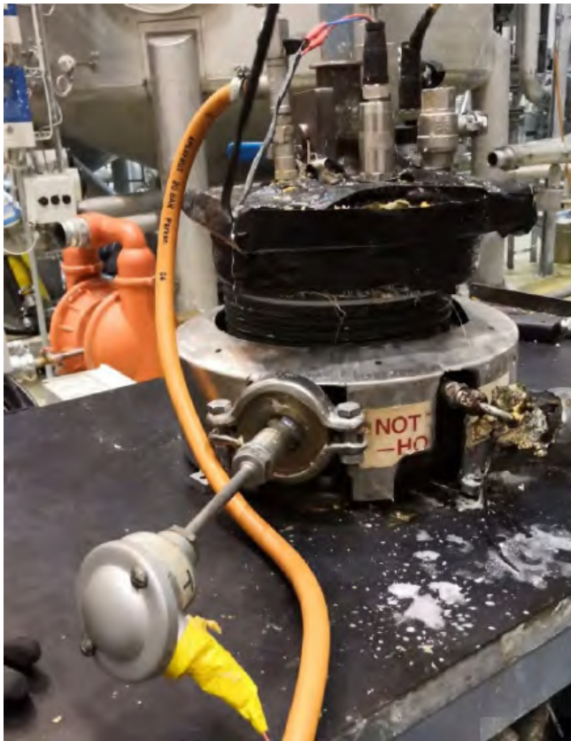
KUVA 1. Mark-reaktoriin asennettu lämpötila-anturi reaktorin kyljessä ja toinen lämpötila-anturi kannessa (kuva Antti Pappinen).
