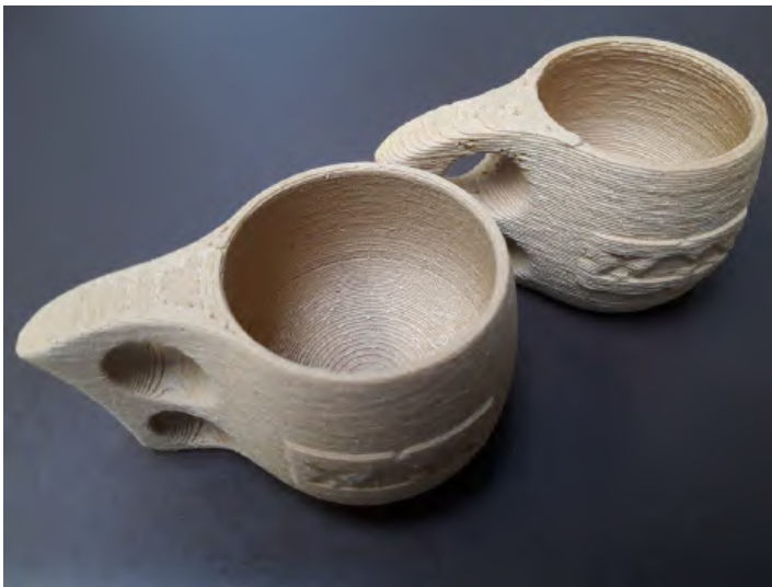
KUVA 2. Bioprintterillä Stora Enson DuraSensestä (50 % puuta + 50 % PP) tulostettuja kuksia (kuva Ilkka Vanttaja).
