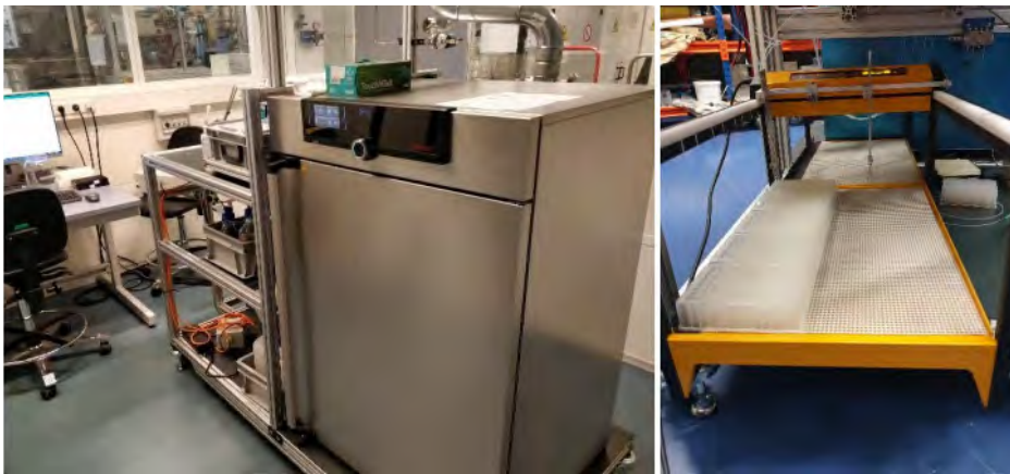
KUVA 5. Suuren suorituskyvyn nesteadsorption demonstraatiolaitteisto, engl. A dedicated high throughput liquid adsorption demonstration unit (Kuva Avantium)
