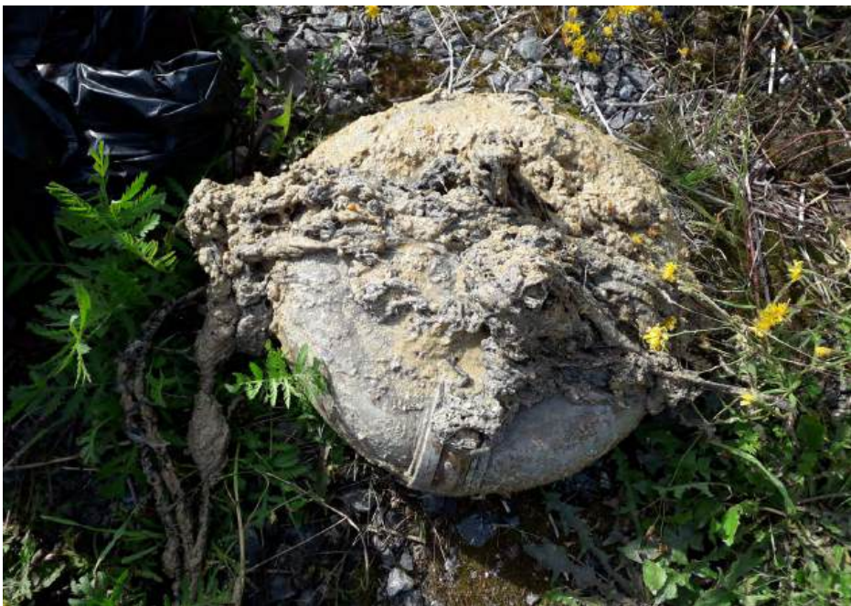
KUVA 4. EHP Environment Oy:n asentamiin antureihin heinäkuussa 2021 kerääntynyt likaa (kuva Riina Tuominen).
