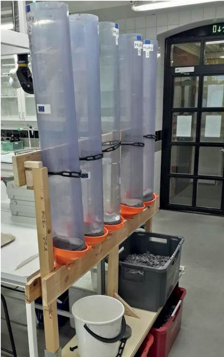
KUVA 6. Laboratoriotestejä varten rakennettu kolonniteline (kuva Aki Mykkänen).
