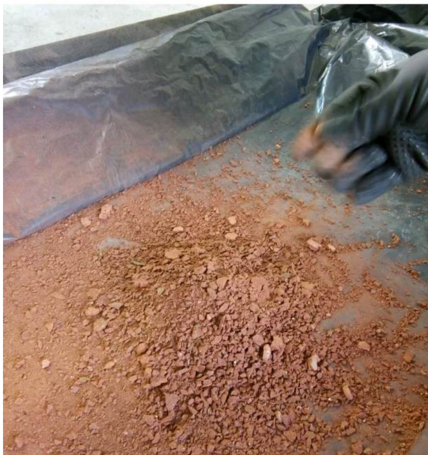
KUVA 1. Tiili valssimurskauksen jälkeen (kuva Eveliina Kuokkanen).
