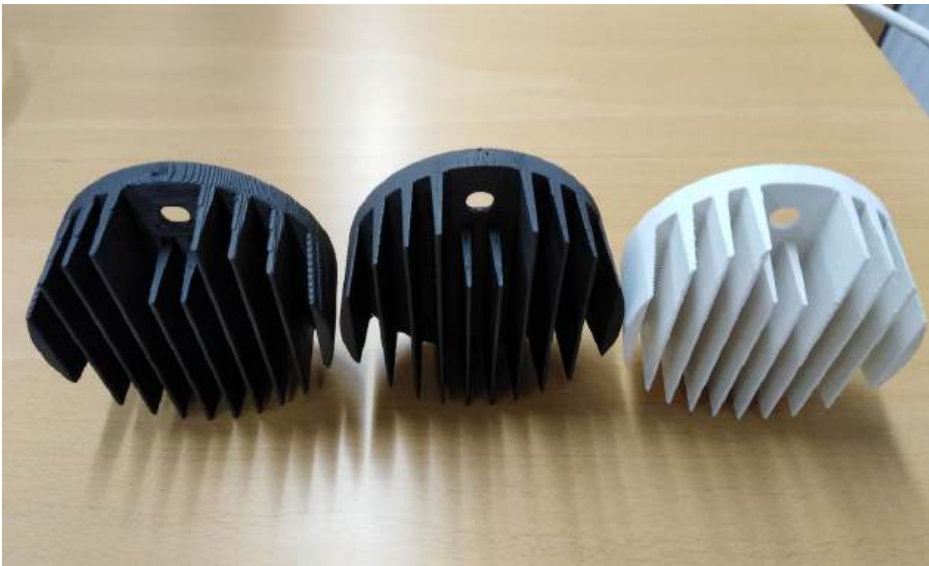
KUVA 1. Vasemmalla TCPoly Ice9 Rigid -materiaalista 0,8 mm:n suuttimella 3D-tulostettu, keskellä samasta materiaalista 0,5 mm:n suuttimella 3D-tulostettu ja oikealla ABS-muovista 0,4 mm:n suutinkoolla 3D-tulostettu jäähdytyselementti (kuva Eetu Huttunen).
