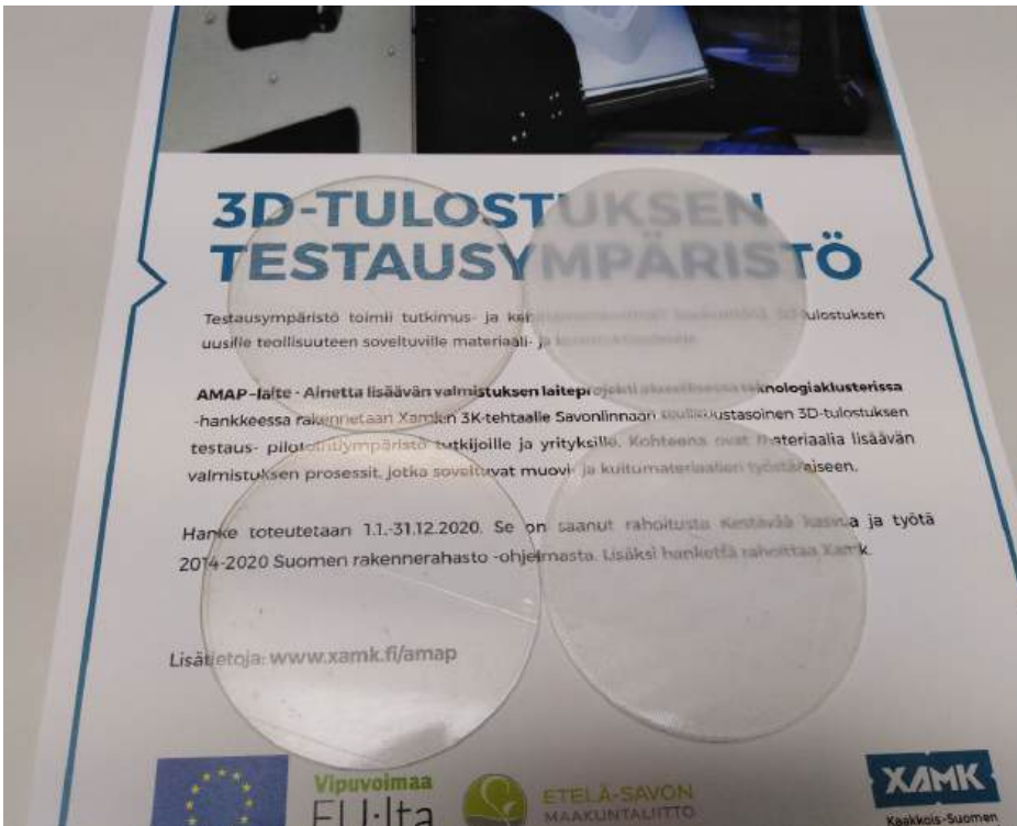
KUVA 4. FDM-tulostetut LED-valaisimen suorat etulevyt/linssit. Kuvassa vasemmalla ylhäällä 0,05 mm:n kerroskorkeudella tulostettu linssi HD glass -materiaalista ja vasemmalla alhaalla sama, mutta hiottuna ja lakattuna. Oikealla ylhäällä 0,05 mm:n kerroskorkeudella Durabio-materiaalista tulostettu linssi ja oikealla alhaalla sama, mutta hiottuna ja lakattuna. (kuva Eetu Huttunen)
