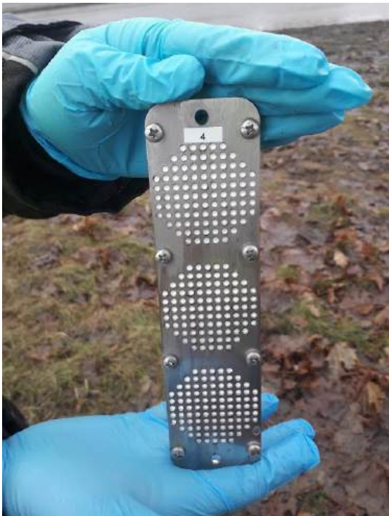
KUVA 1. Uumo-hankkeessa kehitetty passiivinäytteenotin kloorifenolien havaitsemiseen (kuva Aki Mykkänen).
