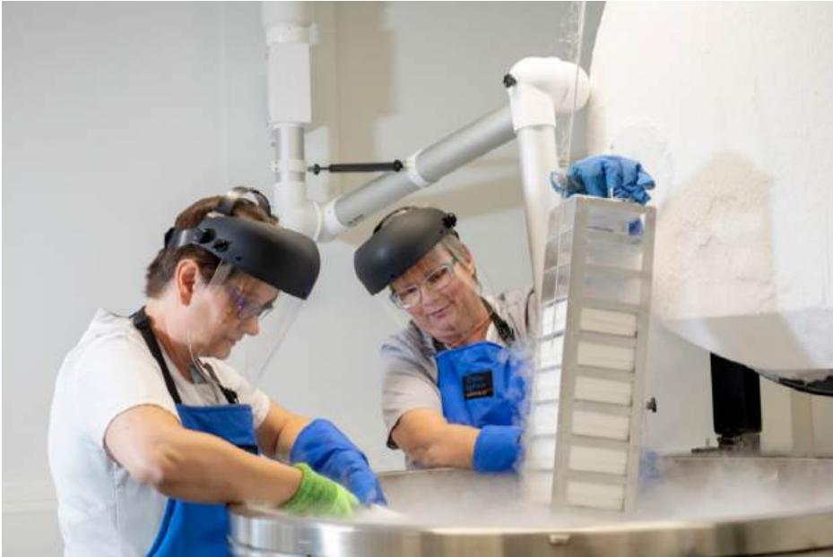
KUVA 1. Kasvu1-toimitilassa on moderni kryolaboratorio, jonka nestetyypitankkeissa on tilaa yli 40 000 syväjäädetytyn näytteen säilyttämiseen (kuva Luonnonvarakeskus).
