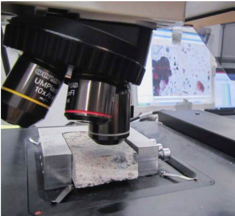
KUVA 3. Betonin pakkasenkestävyyttä tutkitaan esimerkiksi huokosjakomäärityksen avulla pinta- tai ohuthieestä (kuva Anna Eskola, 2016).
