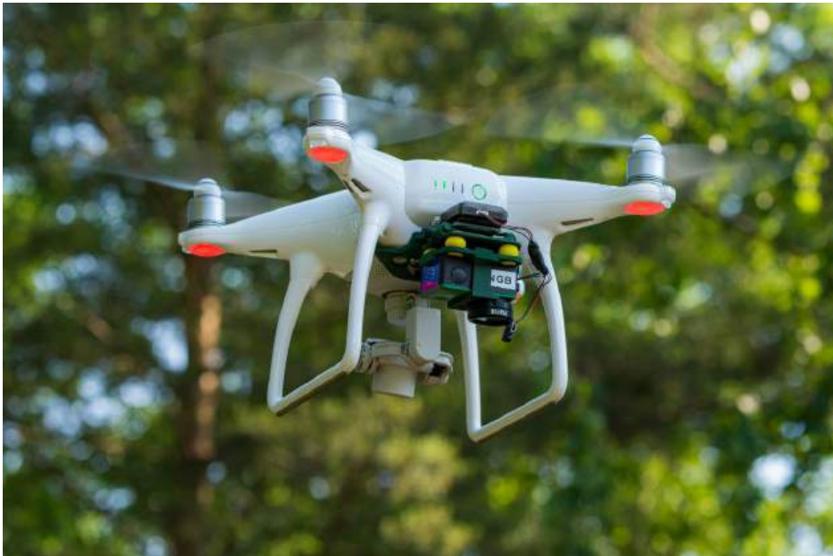
KUVA 3. Multispektrikuvausta dronen avulla (kuva Aki Mykkänen).
