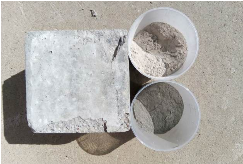
KUVA 1. Esimerkki puristuslujuustestissä käytetystä betonikuutiosta, lisäksi ylemmässä näytepurkissa on G2J1-tuhkaa ja alemmassa kivihiilen lentotuhkaa (kuva Eveliina Kuokkanen).
