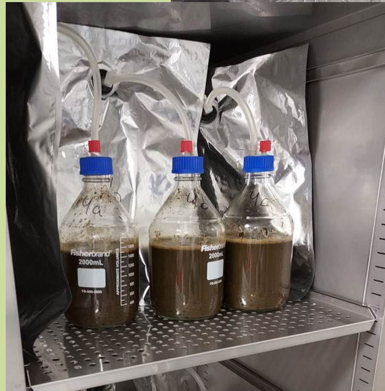
Laboriormittakaavan biokaasureaktorit (kuvat: Tuija Ranta-Korhonen)
