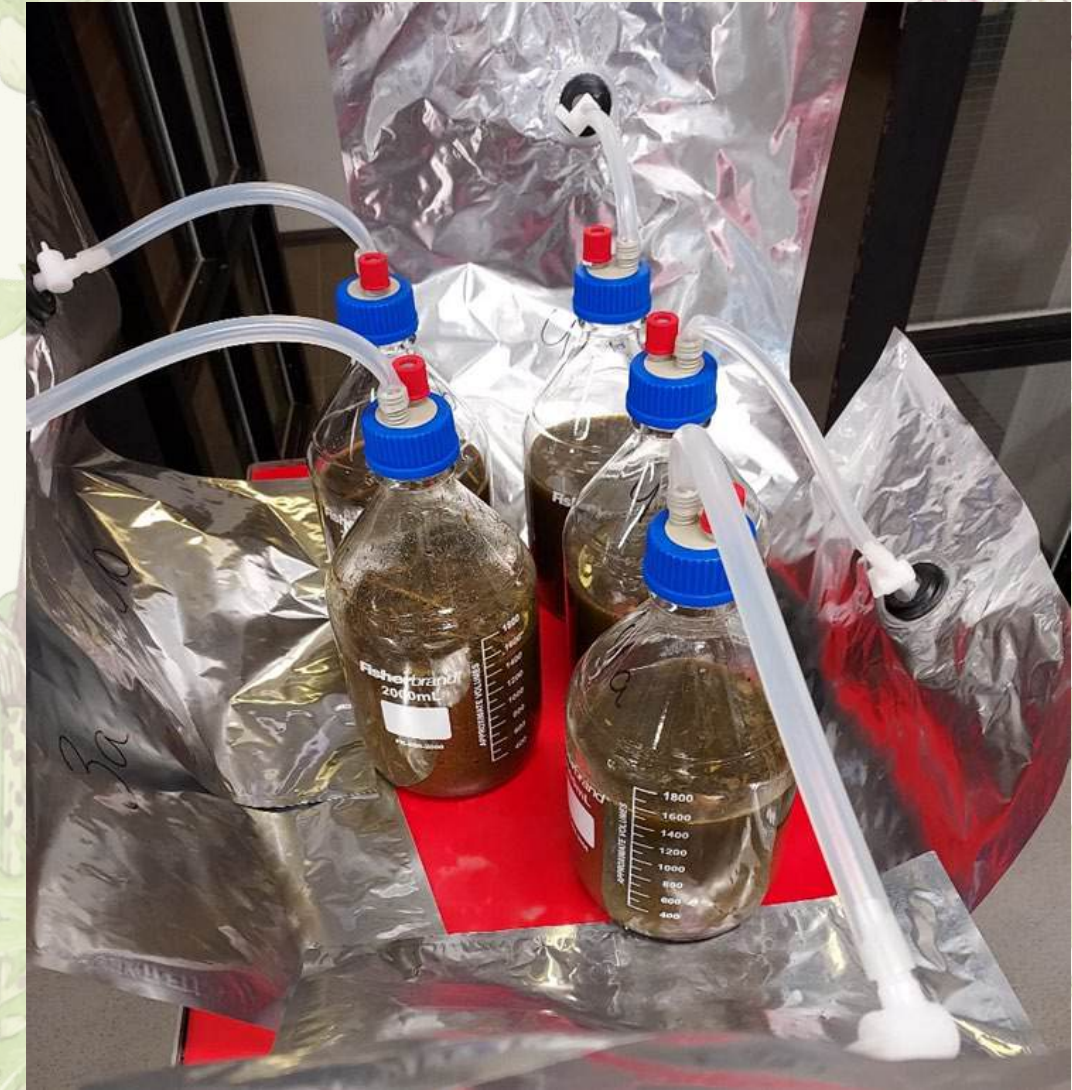
Laboratoriomittakaavan reaktorit ja kaasupussit (kuva: Tuija Ranta-Korhonen)
