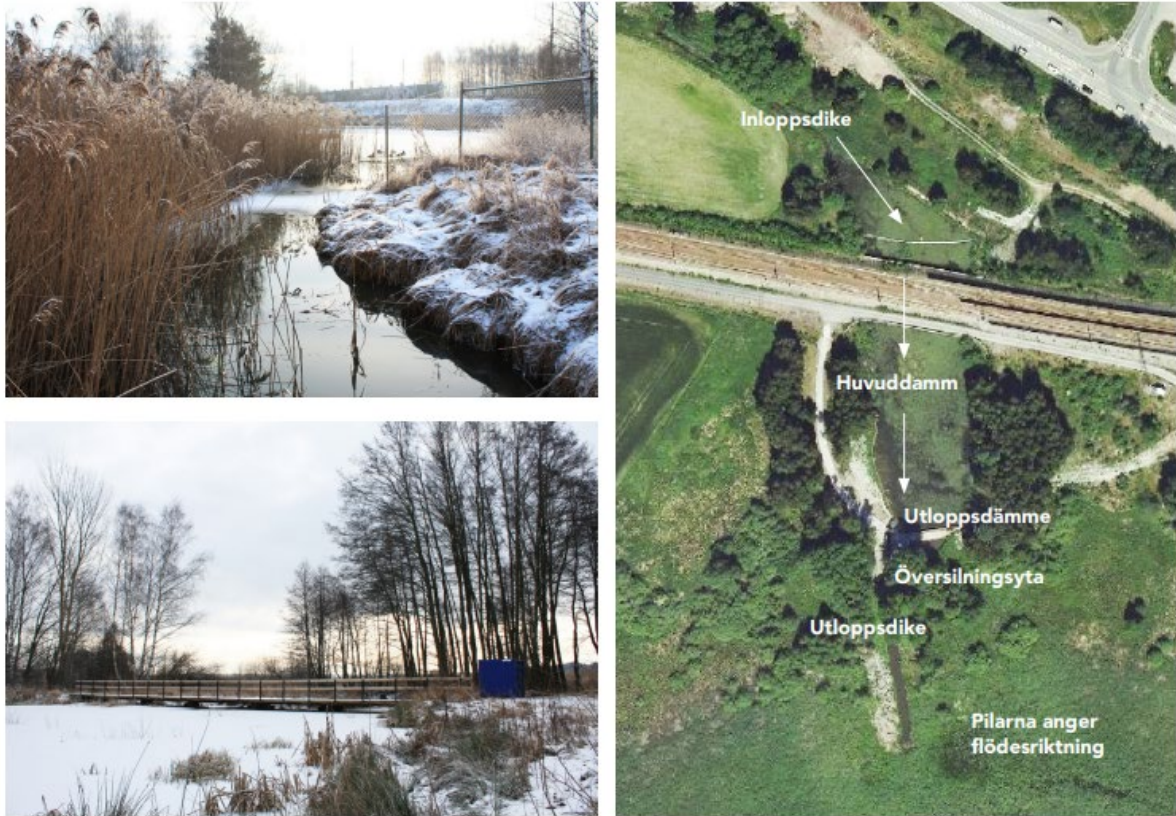
Kuva 22. Tibbledammenin hulevesien käsittelyjärjestelmä (Alm 2010).
